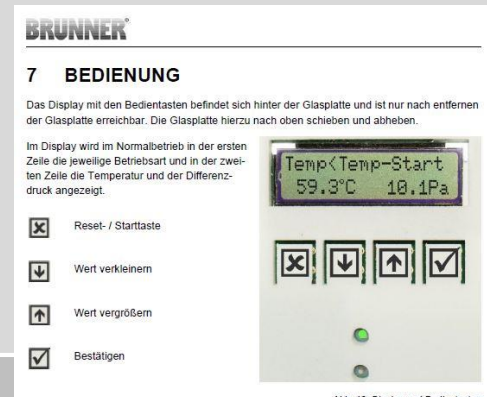
Abb. 13: Display und Bedientasten
