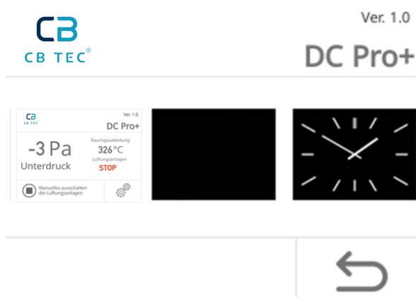
Die dritte Möglichkeit ist, daß LCD nach 2 Minuten in den UHR Modus umschaltet und die Standarddaten werden erst nach dem Drücken auf das LCD angezeigt.
