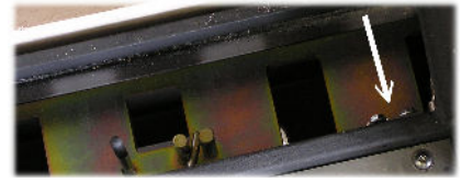
Abb.6: Ausbau Türkontaktschalter (HKD 2.2 und 2.6 abweichend)
