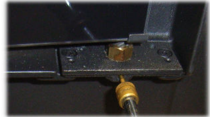
Abb. 11: Ausbau der Gewindehülse
