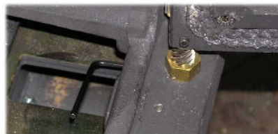
Abb.4: Lösen der Arretierung (HKD 2.2 und 2.6 abweichend)
