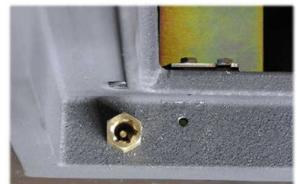
Abb.9: Neue Gewindehülse mit Schaltstift (HKD 2.2 und 2.6 abweichend)
