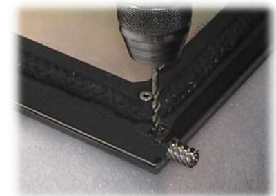
Abb. 14: Bohren für Spannstiftmontage
