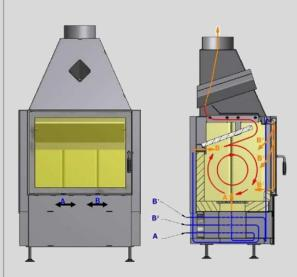
Regler A dient der stufenlosen Regelung der Luft unter dem Feuerrost. Beim Verschieben des Schiebers nach rechts wird der Luftstrom erhöht, beim Verschieben nach links wird der Luftstrom reduziert.
