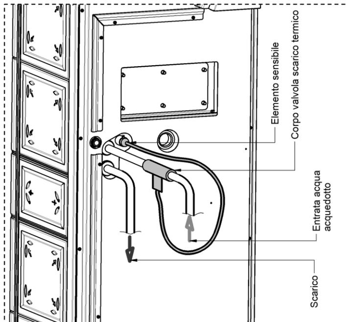
Wird ein thermisches Ablaufsicherungsventil installiert, muss ein zertifiziertes und tariertes Zwei-Wege-Ventil nach den Anweisungen des Ventilherstellers am Eingang des Wärmetauschers installiert und eine Rohrleitung für den verlorenen Abfluss vorgesehen werden. Das Ventil für den thermischen Abfluss hat die folgenden Eigenschaften:
