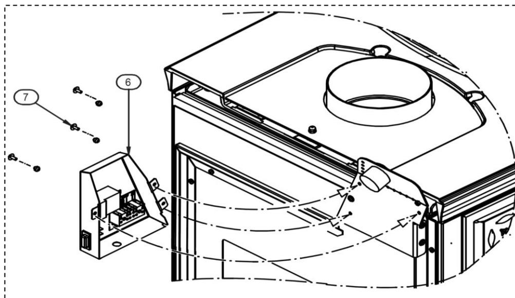
Die Stromversorgung ist an die Klemmen (220 V) anzuschließen, wie in der nachstehenden Abbildung gezeigt. Dann die Umwälzpumpe an die Klemmen (PUMPE) anschließen. Auf diese Weise wird die Umwälzpumpe in Betrieb genommen, sobald das Wasser im Kessel eine Temperatur von etwa 60°C überschreitet.
