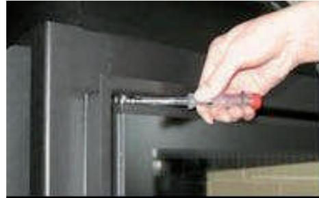
Schwenken Sie die Tür auf. Anschließend ziehen Sie die Innensechskantschraube am unteren Scharnier mit einem 2 mm Sechskantschlüssel fest.
