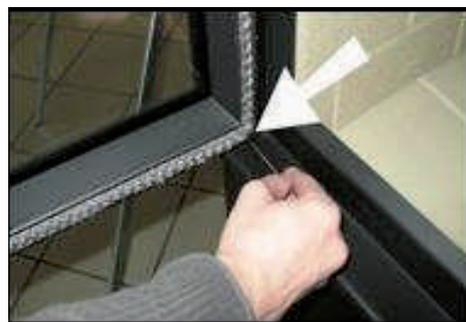
Fassen Sie die Tür von unten. Mit einer leichten Hubbewegung heben Sie die Tür etwas an, damit der untere Zapfen des Scharniers freiliegt.
