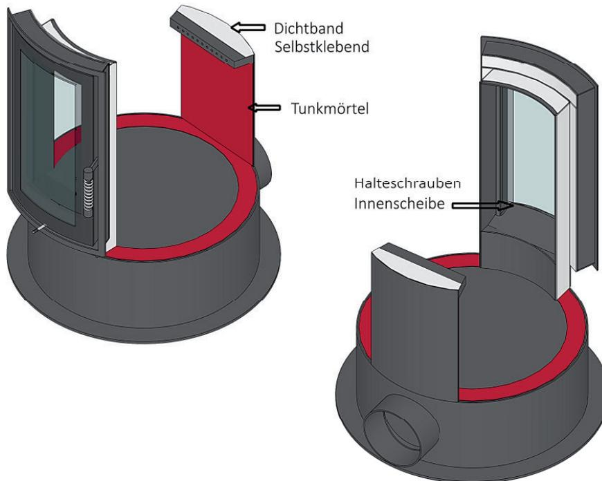
Um die Heiztür muss vor dem Einbau ein selbstklebendes Dichtband angebracht werden.
