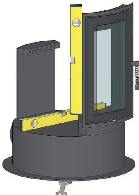
Podest mit Heiztür genau platzieren und mit einer Waage ausrichten.
