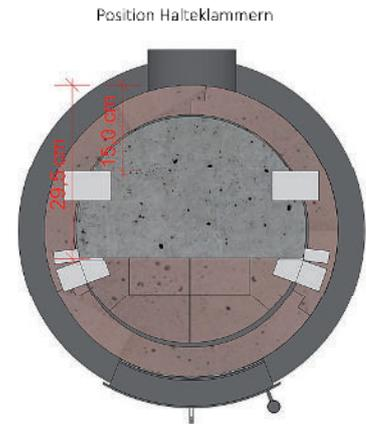
Halteklammern einhängen und Umbrandstein Nr. 1 lose einlegen.
