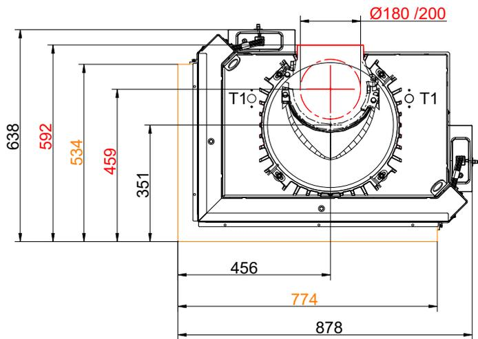
... links mit Anbaurahmen und Wärmetauscherringe Guss + Gusskuppel
