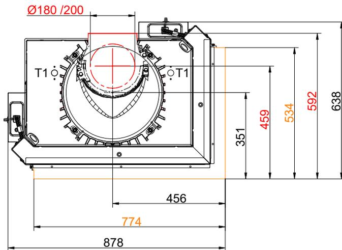
... rechts mit Anbaurahmen und Wärmetauscherringe Guss + Gusskuppel
