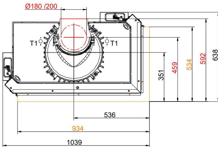
... rechts mit Anbaurahmen und Wärmetauscherringe Guss + Gusskuppel
