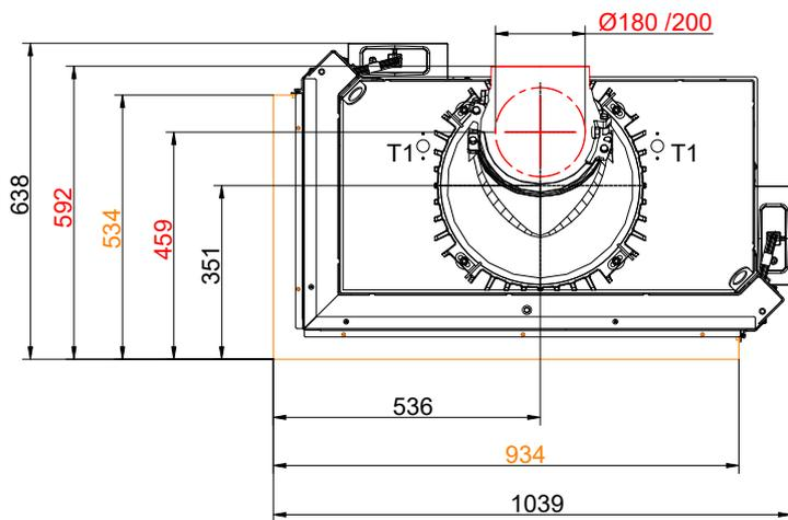
... links mit Anbaurahmen und Wärmetauscherringe Guss + Gusskuppel
