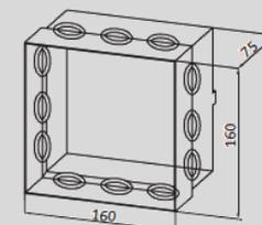
Der Unterputzkasten für die Ofensteuerung wird in einem kalten Wandbereich auf Sichthöhe montiert.
