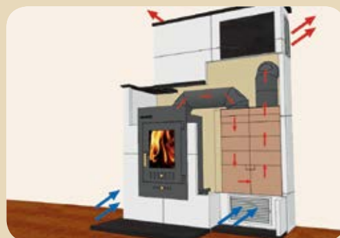
... als Kombigerät (mit Anbindung an das Heizsystem) und Nachheizkasten.
