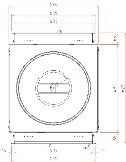
Seitenansicht Drehzug für Wand- oder Deckenanschluss M 1:20
