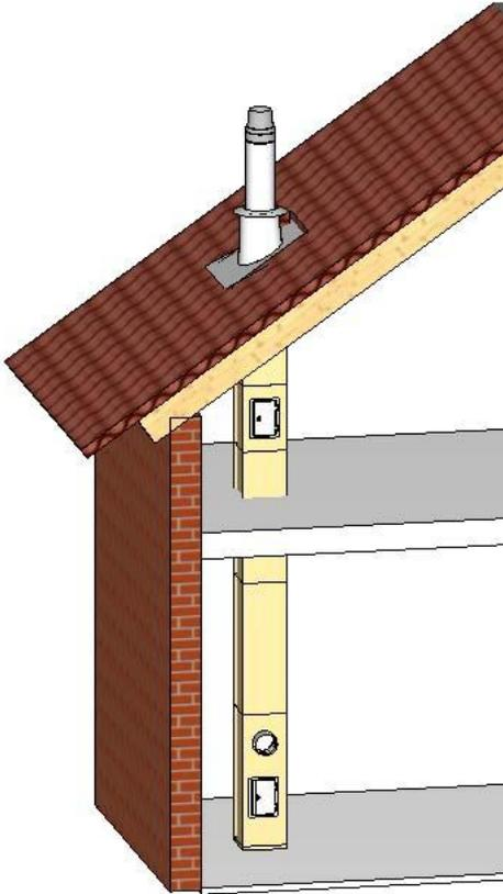
**KaminoFORM S** ist ein überaus flexible, modular einbaubare Leichtbau-Abgasanlage. Sie ist die universelle Ideallösung für die Verkleidung von innen gelegenen Kaminrohren.
